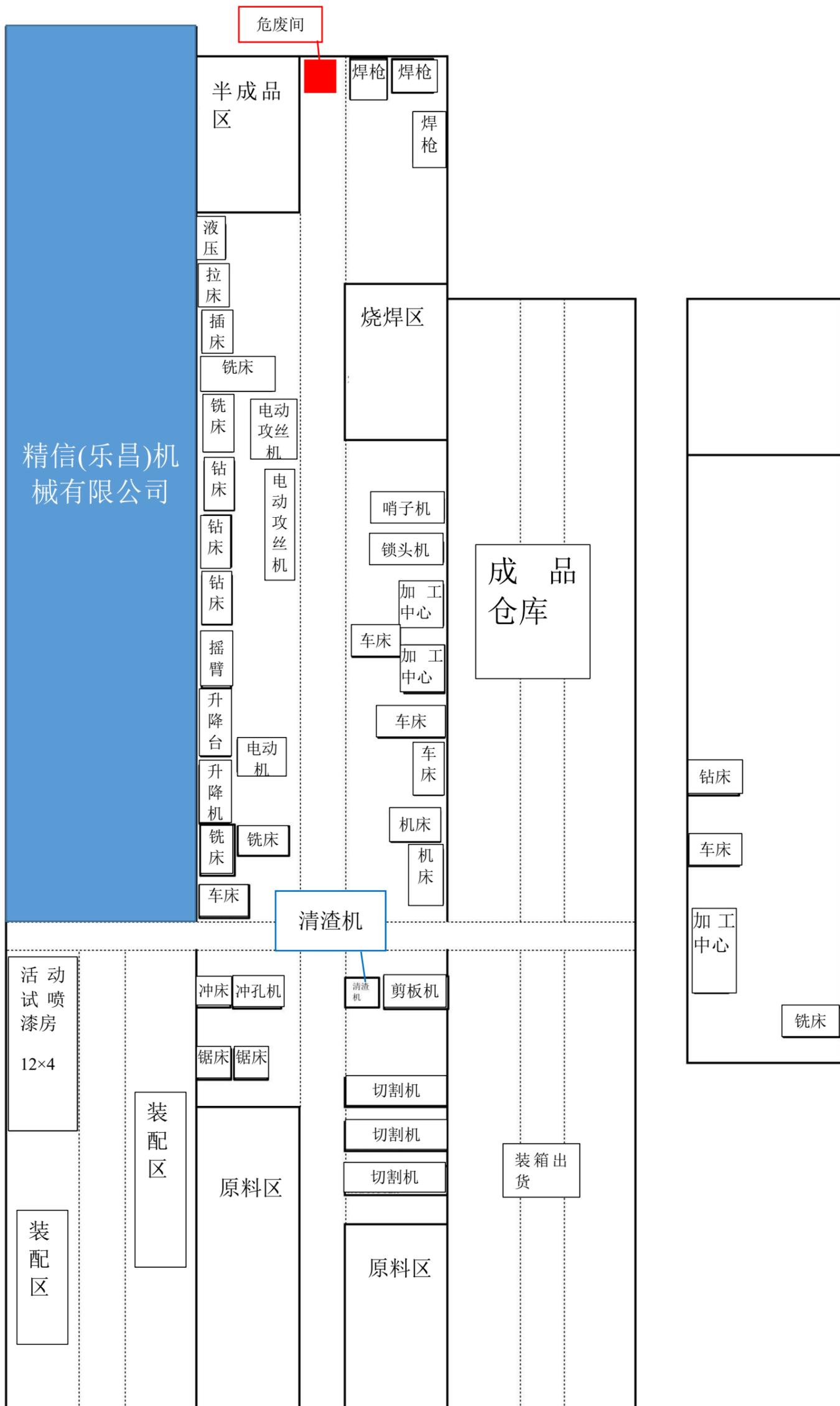
附图4-2项目加工生产线平面布置图
